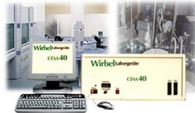
Der Computerschnellanalysator CESA 40 mit 20-facher automatischer Probenzuführung wurde zur exakten und komfortablen Bestimmung von **Schwefel und Kohlenstoff** in Kohle, Koks, Ölen, Gips, Asche, Zement, Metallen und anderen Feststoffen entwickelt.
